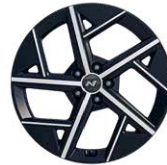
8,5 J x 20-Zoll-Leichtmetallfelgen mit 255/45 R 20 Bereifung (serienmäßig für N Line und N Line X)
